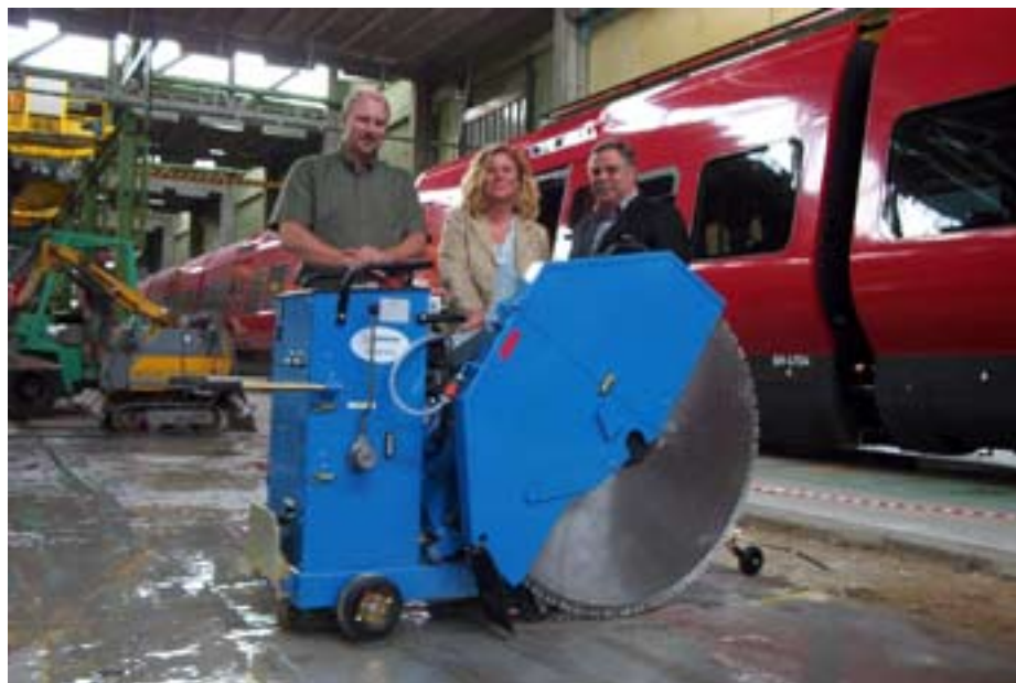
”Tre x Brandt i aktion, (fra venstre) Bjarne Brandt Pedersen, Jeanette Brandt og Niels Brandt med den nyeste 25 HK diamantsav med 1200 mm klinge. Trods det massive værktøj kræver netop denne opgave fintfølelse, da DSB skal bruge serviceværkstedet samtidigt med, at Brandt Diamant opskærer og fjerner 1.500 tons beton.”
